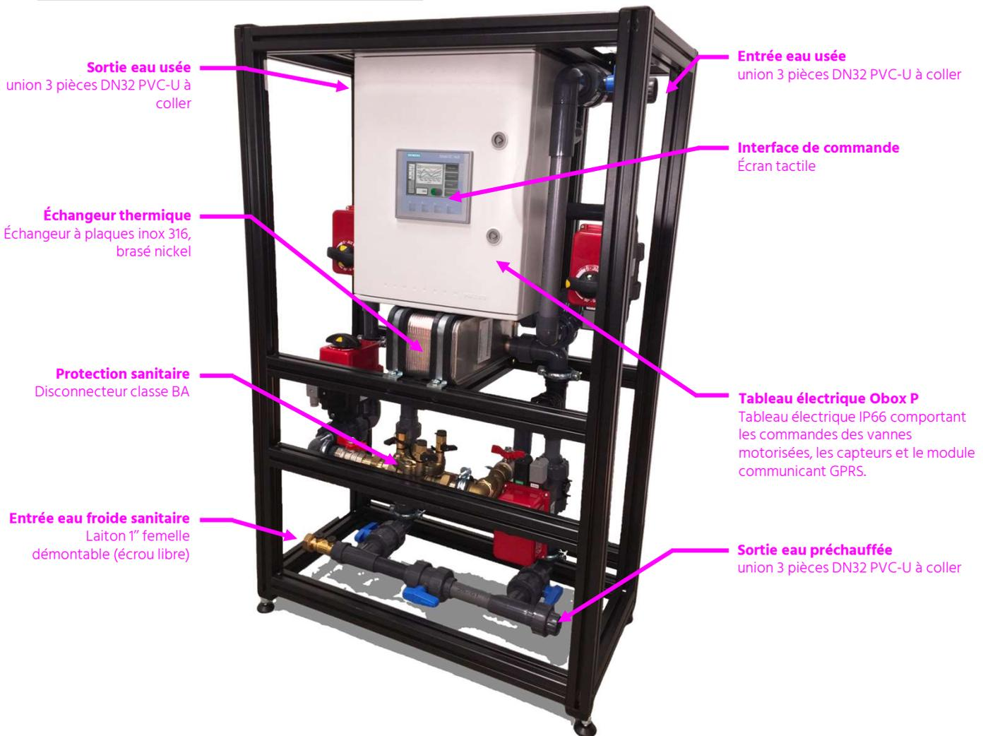
**Type d'eau traitée** : Obox P peut traiter de l'eau contenant jusqu'à 5 ppm de chlore libre ( $Cl_2$ ). Il est compatible avec les eaux calcaires de France métropolitaine jusqu'à 40 °f.
