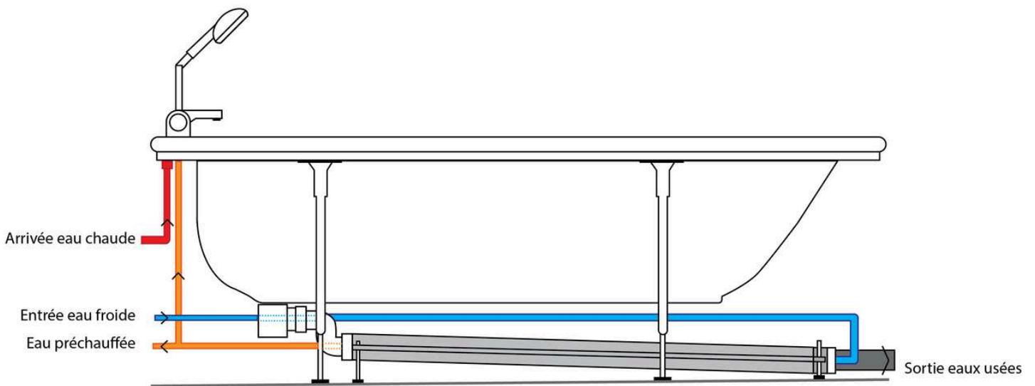
**Le côté le plus plat de l'Evobox sera toujours orienté vers le sol qu'il soit installé sous la baignoire ou en sous-face de dalle.**
